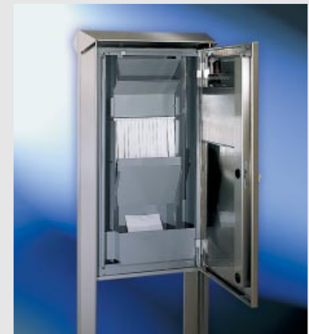
Abb. 243/3 Sicherheitsfallschacht mit zwei beweglichen Rückholsperren. Um die Funktion des Fallschachtes zu gewährleisten sowie ausreichend Volumen zu bieten, sollten folgende Mindestgrößen unbedingt eingehalten werden: • Freistehende Anlagen mindestens 455 x 990 x 145 mm • Anlagen im Türseitenteil mindestens 370 x 880 x 145 mm
