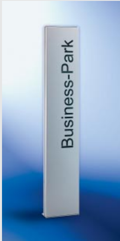
Abb. 202/1 Stahl-Säule, pulverbeschichtet, Beschriftung durchgraviert mit lichtdurchlässigem Polyester flächenbündig ausgegossen, beleuchtet. Säulenhöhe 1700 mm. Auch als Wandelement möglich.
